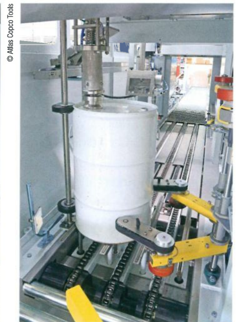
Abb. 3: Blick aus Richtung der Leerfässbahn in die Abfüllanlage: Die Schraubglocke hat gerade auf dem Spundloch des lagezentrierten Fasses aufgesetzt, und der LZB-Motor am Kopf der Glocke (aus dieser Perspektive nicht sichtbar) beginnt mit dem Schrauben.
