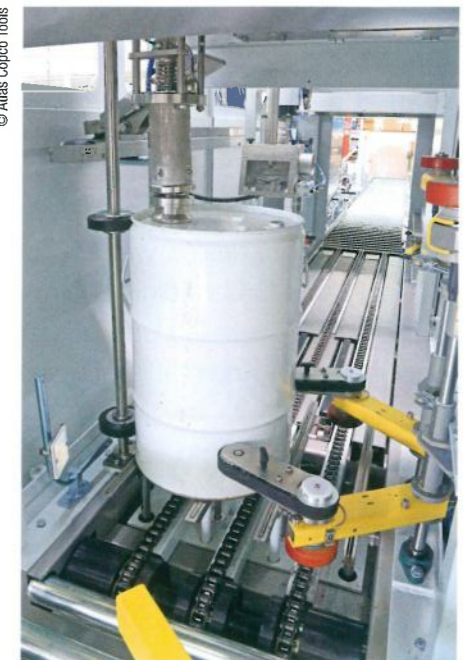
Abb. 3: Blick aus Richtung der Leerfässbahn in die Abfüllanlage: Die Schraubglocke hat gerade auf dem Spundloch des lagezentrierten Fasses aufgesetzt, und der LZB-Motor am Kopf der Glocke (aus dieser Perspektive nicht sichtbar) beginnt mit dem Schrauben.
