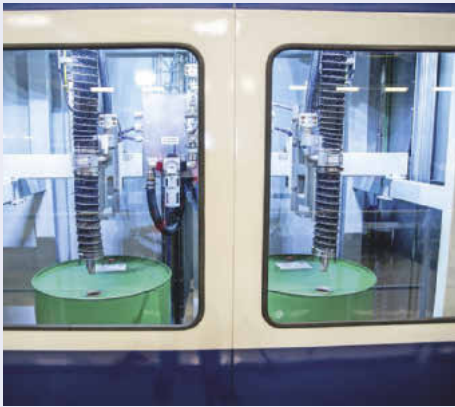
Zwei Fässer werden parallel befüllt, sodass sich die Leistung von 60 auf 120 Fässer pro Stunde verdoppelt
