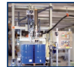
Automatische Palettenfüllmaschine Typ 37 Eine Maschine, die Ihre Fässer auf der Palette automatisch befüllt, Positionierung durch Teach-In
