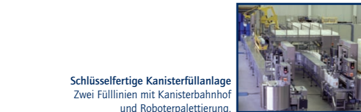
Kanisterfüllautomat mit Vierfach-Stationen zum Positionieren, Füllen und Verschließen
