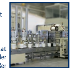
Automatische Eimerfüllmaschine Eine Maschine, die Ihre Eimer automatisch befüllt und mit Deckeln verschließt
