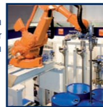
RobotFiller Typ 91 hochflexibel durch Knickarmroboter mit Kamerasystem
