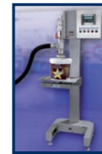
Eimerfüllstation Typ 14 Eimerbefüllung mit Produktstromregelung
