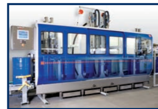
Automatische Fassfüllmaschine Typ 32 Eine Maschine, die Ihre Fässer automatisch aufschraubt und befüllt
