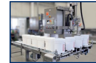
Füllrapid Hochleistungsfüllautomat mit konstantem Produktstrom
