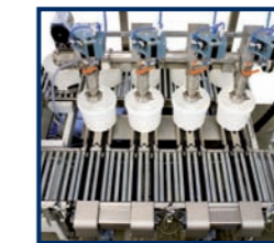
Füllrapid Hochleistungsfüllautomat mit konstantem Produktstrom
