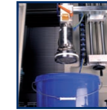
Füllstation Typ 14 für die Befüllung von Beuteln im schützenden Umkarton
