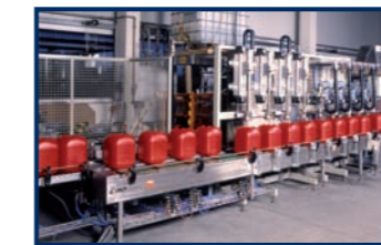
Automatische Kanisterfüllmaschine Typ 34 Eine Maschine, die Ihre Kanister automatisch befüllt (Vor- und Fertigfüllung) und zuschraubt
