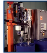
Fassfüllanlage Typ 29 Ein Halbautomat, der mit vielen Zusätzen Ihre Abfüllprozesse wirtschaftlicher und sicherer macht
