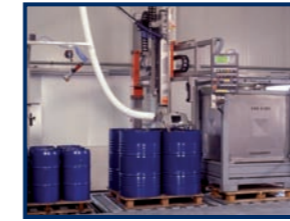
Palettenfüllstation Typ 16 mit zusätzlichem Füllplatz für kleinere Kanister
