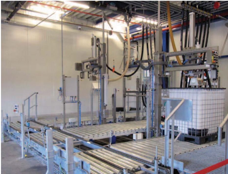
Säuren- und Laugenabfüllung mit Feige-Abfüllanlagen Typ 16.1-B-20n.
