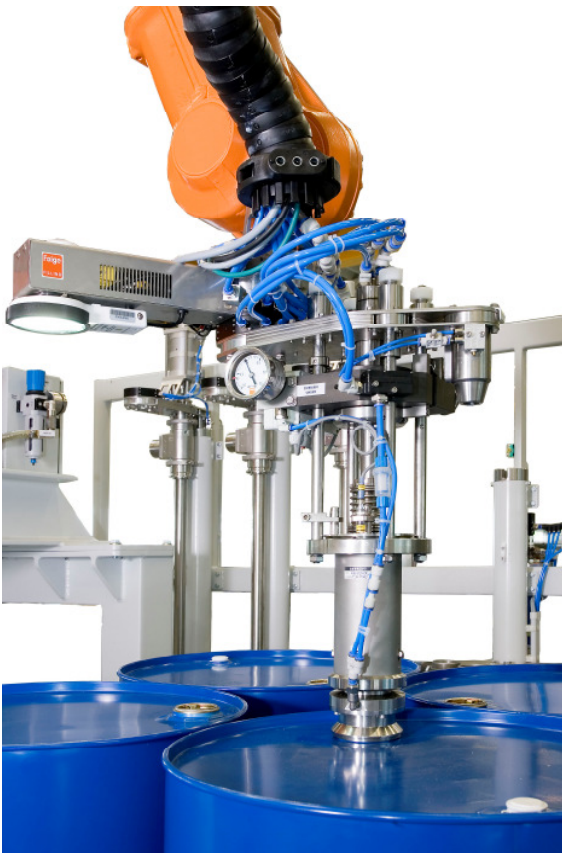
Bild: Roboter mit aufgenommenen Schrauberwerkzeug
